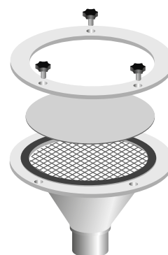
Dettaglio portafiltro per la raccolta del Particolato totale PTS
